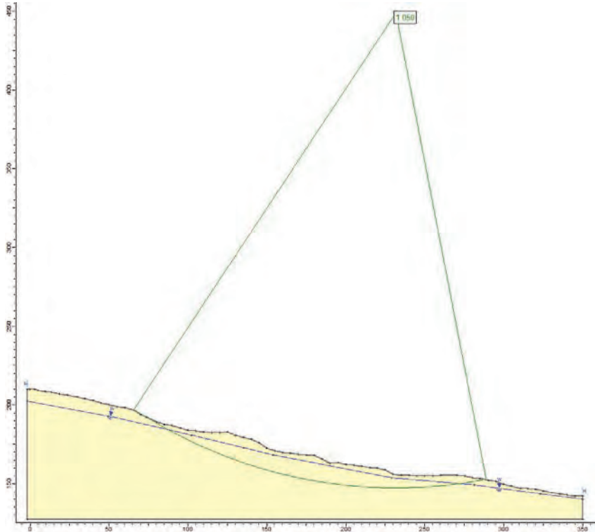
Şekil 4. 1-1' kesit hattındaki heyelanın statik şartlarda kayma dairesi ve güvenlik sayısı.
